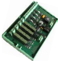
Digital-IO-Adapter mit 4 Eingängen und 4 Relais zur Ansteuerung von Lasten
