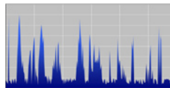
Hüllkurve des Sprachsignals 250Hz-Band
